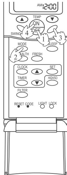
Пульт ДУ имеет функцию запоминания последних установок (температуры и скорости вентилятора) в каждом из режимов работы кондиционера. Однажды установив желаемые температуру и скорость вентилятора в каждом из режимов работы кондиционера, Вы можете одним нажатием кнопки MODE выбрать требуемый режим работы кондиционера с Вашими любимыми установками. К сожалению, данная возможность не относится к установкам таймера включения/выключения (TIMER ON/OFF).
