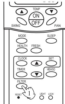
2. Нажмите кнопку «  $\nabla$  », отвечающую за регулировку температуры или времени «  $\nabla$  » в режиме ожидания, после чего начнёт действовать механизм, вызывающий движение фильтра по направлению вниз данный процесс не остановится до тех пор, пока не будет достигнут максимальный предел.
