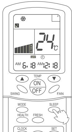
**Примечание.** Если на пульте ДУ кондиционера отсутствует кнопка SLEEP, то данную последовательность действий можно осуществить, используя кнопку SWING.
